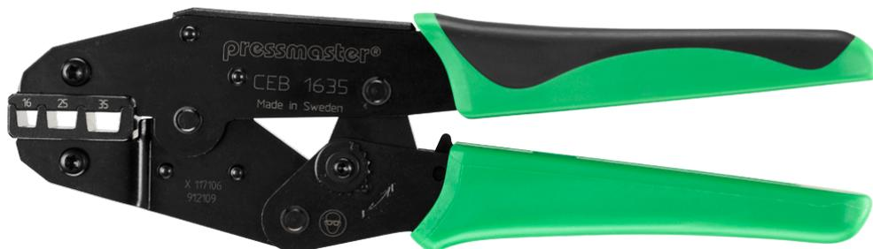
CEB-1635 ist ein Crimpwerkzeug für Aderendhülsen nach DIN 46228, 16 mm<sup>2</sup> - 35 mm<sup>2</sup>/AWG 6-2, Zuführung seitlich, Trapez-Crimp.
