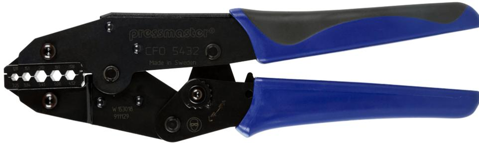
CFO-5432 ist ein Crimpwerkzeug für Glasfaserstecker; 3,25 mm; 3,84 mm; 5,41 mm; 5,00 mm; 4,52 mm/0,128"; 0,151"; 0,213"; 0,197"; 0,178", Sechskant-Crimp, ST, SC, SMA, SMB, SFR.
