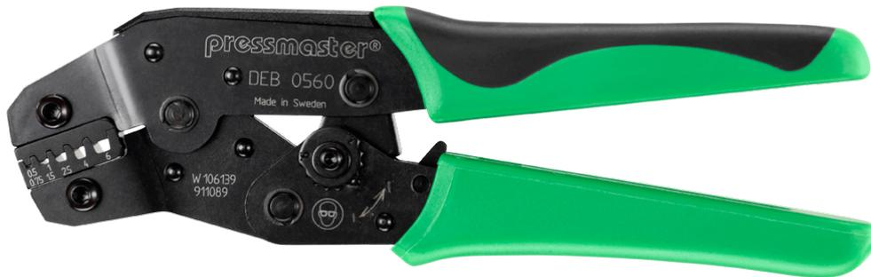
DEB-0560 ist ein Crimpwerkzeug für Aderendhülsen nach DIN 46228, 0,25-6 mm<sup>2</sup>/ AWG 24-10, Zuführung seitlich, Trapez-Crimp.
