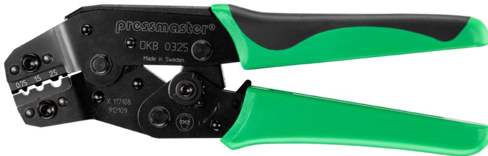
DKB-0325 ist ein Crimpwerkzeug für unisolierte Steckverbinder, 0,5 - 2,5 mm<sup>2</sup>/AWG 22-14, Indent-Crimp.
