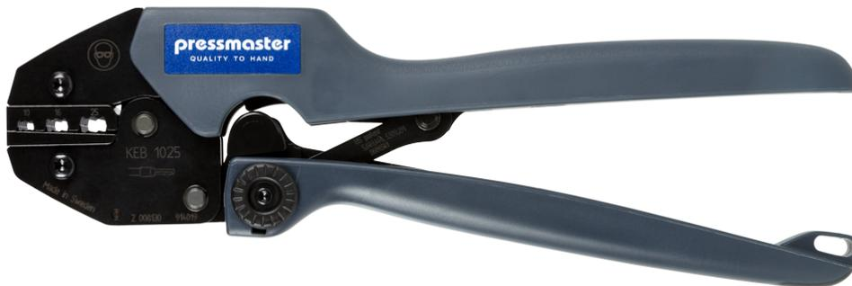
KEB-1025 ist ein Crimpwerkzeug für Aderendhülsen nach DIN 46228, 10 mm<sup>2</sup> - 25 mm<sup>2</sup>/AWG 6-4, Zuführung seitlich, Trapez-Crimp.
