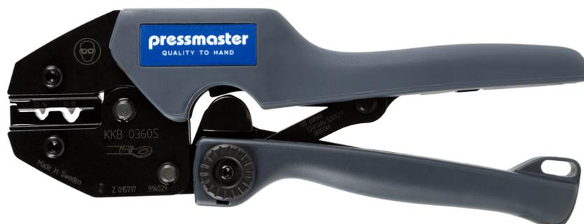
KKB-0360S ist ein Crimpwerkzeug für unisolierte Steckverbinder, 0,35-6,0 mm<sup>2</sup>/AWG 22-10, Indent-Crimp.
