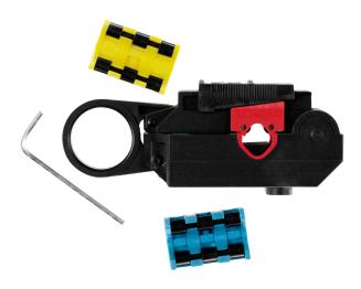
Maxi Corex ist ein Abisolierwerkzeug für Koaxialkabel Ø 7,0 bis 15,0 mm / 0,28 bis 0,55 ", 3-Blatt, Abisolierlänge 9,5 + 3,2 mm / 0,374 + 0,126".
