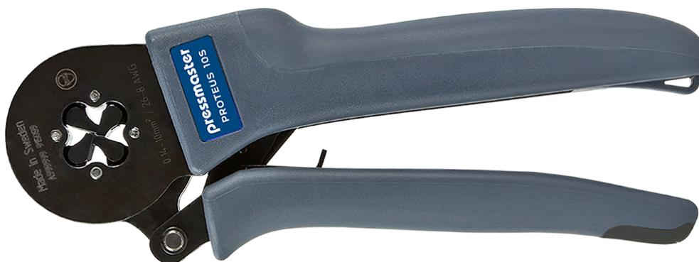
Proteus ist das leichteste und kompakteste Crimpwerkzeug seiner Bauart. Die geringere Größe bedeutet jedoch keine geringere Leistung. Mit dem Mechanismus zur Erfassung des Verbinderschnitts wird für die Verpressung von Aderendhülsen mit einem Querschnitt von 0,14-10,0 mm<sup>2</sup>/AWG 26-8 nicht mehr Kraft benötigt als für einen festen Händedruck. Proteus ist ein leistungsstarkes Werkzeug, das einen Qualitätscrimp garantiert.
