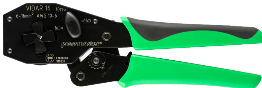
VIDAR 16 ist das Original und nach wie vor die beste Crimpzange mit selbsteinstellenden Gesenken zur Herstellung eines quadratischen Crimpprofiles für Aderendhülsen von 6,0-16,0 mm<sup>2</sup>/AWG 10-6 (hergestellt nach DIN 46228-Teil 4 oder UL 486F).
