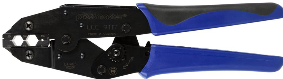
CCC-9117 es una herramienta crimpadora para conectores CATV; 8,23 mm; 9,14 mm; 1,73 mm/0,360"; 0,324"; 0,068"; crimpado hexagonal.
