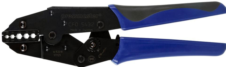
CCC-5432 es una herramienta crimpadora para conectores de fibra óptica; 3,25 mm; 3,84 mm; 5,41 mm; 5,00 mm; 4,52 mm/0,128"; 0,151"; 0,213"; 0,197"; 0,178", crimpado hexagonal, ST, SC, SMA, SMB, SFR.
