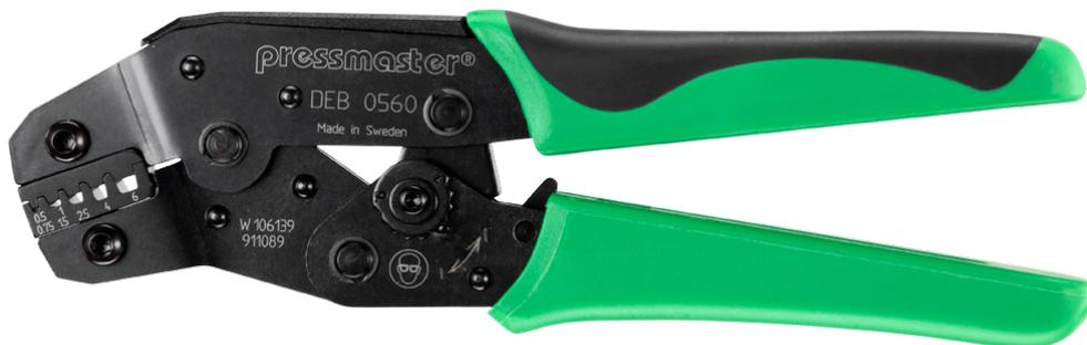
DEB-0560 es una herramienta crimpadora para conectores punta-punta finales conforme a la norma 46228; 0,25-6 mm<sup>2</sup>/ AWG 24-10, con acceso lateral, alicate para entallado trapezoidal.
