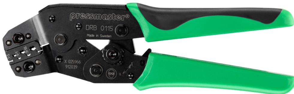
DRB-0115 es una herramienta crimpadora para conectores enchufables no aislados de 2,8 + 4,8 mm, 0,1-1,5 mm<sup>2</sup>/0,110"+0,187", AWG 26-16, «F»/«B».
