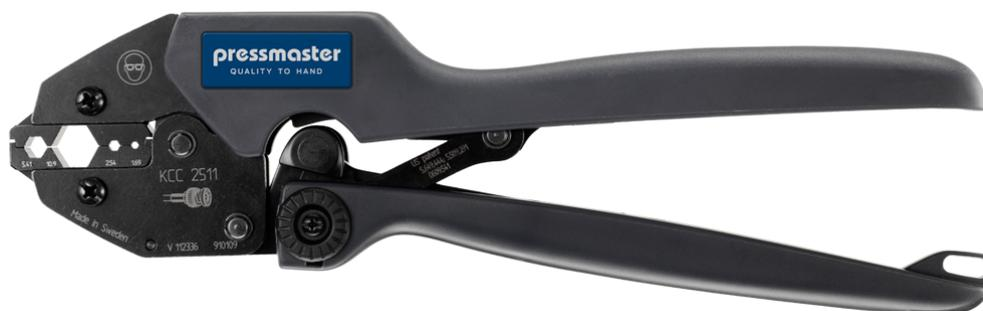
KCC-2511 es una herramienta crimpadora para conectores coaxiales; 10,9 mm; 5,41 mm; 2,54 mm; 1,69 mm/0,213"; 0,429"; 0,100"; 0,067"; crimpado hexagonal.
