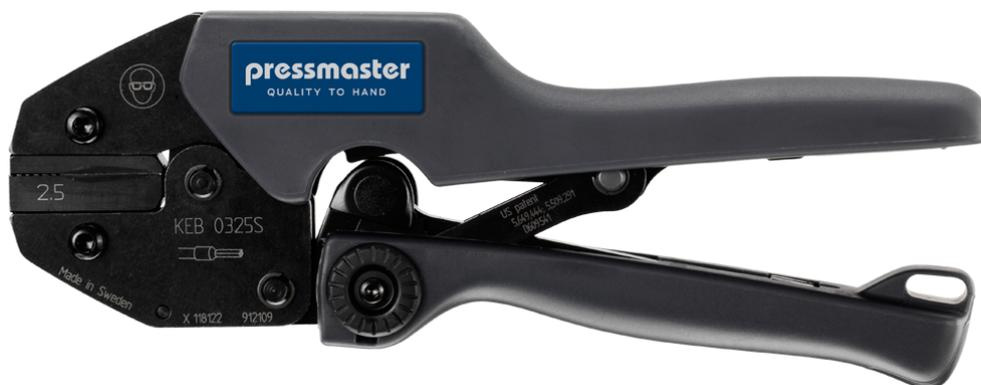
KEB-0325S es una herramienta crimpadora para conectores punta-punta finales conforme a la norma 46228; 0,25 mm<sup>2</sup>; 0,5 - 1,5 mm<sup>2</sup>; 2,5 mm<sup>2</sup> / AWG 24; AWG 22-16; AWG 14, de acceso frontal, alicate para entallado trapezoidal.
