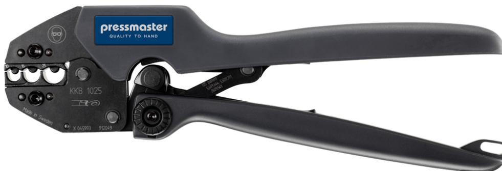
KKB-1025 es una herramienta crimpadora para conectores no aislados, conforme a la norma DIN 46234, 10 - 25 mm<sup>2</sup>/AWG 8-4, Indent-Crimp.
