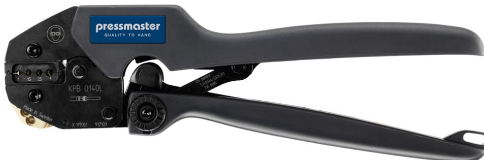
KPB-0140L es una herramienta crimpadora para terminal invertido, 0,14 - 4,0 mm<sup>2</sup>/AWG 26-12, crimpado cuadrado, con localizador.
