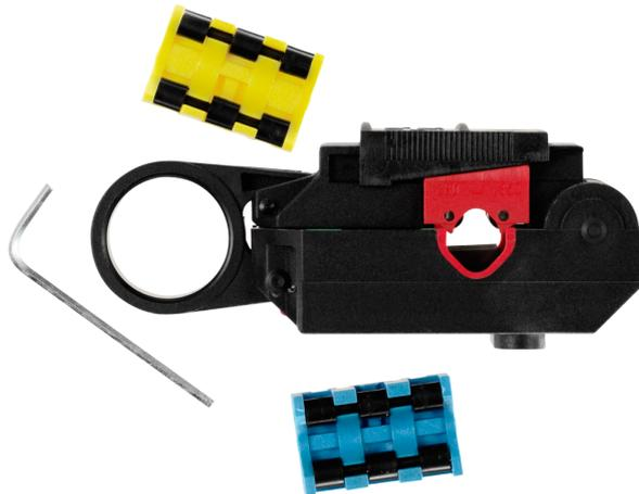
Maxi Corex es una herramienta de pelado de cable coaxial, Ø 7,0 a 15,0 mm / 0,28 hasta 0,55", 3 cuchillas, longitud de pelado de 9,5 + 3,2 mm / 0,374 + 0,126".
