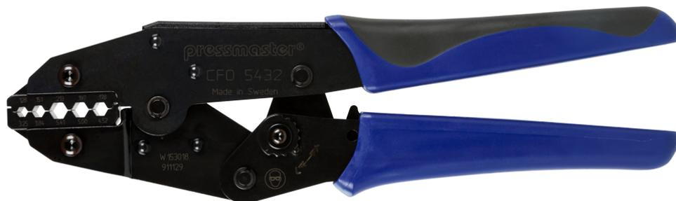
CFO-5432 est un outil de sertissage pour Connecteurs Fibre optique; 3,25 mm; 3,84 mm; 5,41 mm; 5,00 mm; 4,52 mm/0,128"; 0,151"; 0,213"; 0,197"; 0,178", sertissage hexagonal, ST, SC, SMA, SMB, SFR.
