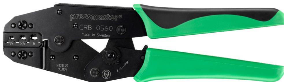
CRB-0560 est un outil de sertissage pour cosses non isolées, 6,3 mm; 0,5 - 6 mm<sup>2</sup>/0,250"; AWG 22-10; sertissage « B/F ».
