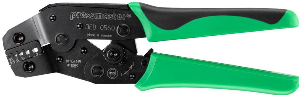
DEB-0560 est un outil de sertissage pour Embouts DIN 46228; 0,25-6 mm<sup>2</sup>/ AWG 24-10, introduction côté, sertissage trapézoïdal.
