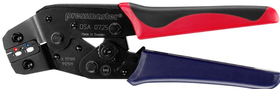
DSA-072 est un outil de sertissage pour connecteurs pré-isolés, 0,75 - 2,5 mm<sup>2</sup>/AWG 22-14 (rouge, bleu), sertissage ovale.
