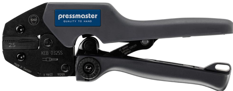
KEB-0325S est un outil de sertissage pour Embouts DIN 46228; 0,25 mm<sup>2</sup>; 0,5 - 1,5 mm<sup>2</sup>; 2,5 mm<sup>2</sup> / AWG 24; AWG 22-16; AWG 14, introduction frontale, sertissage trapézoïdal.
