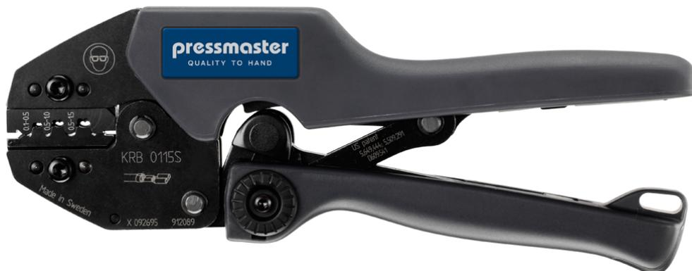
KRB-0115S est un outil de sertissage pour connecteurs à fût ouvert non isolés 2,8 + 4,8 mm, 0,1-1,5 mm<sup>2</sup>/0,110"+0,187", AWG 26-16, sertissage « B/F ».
