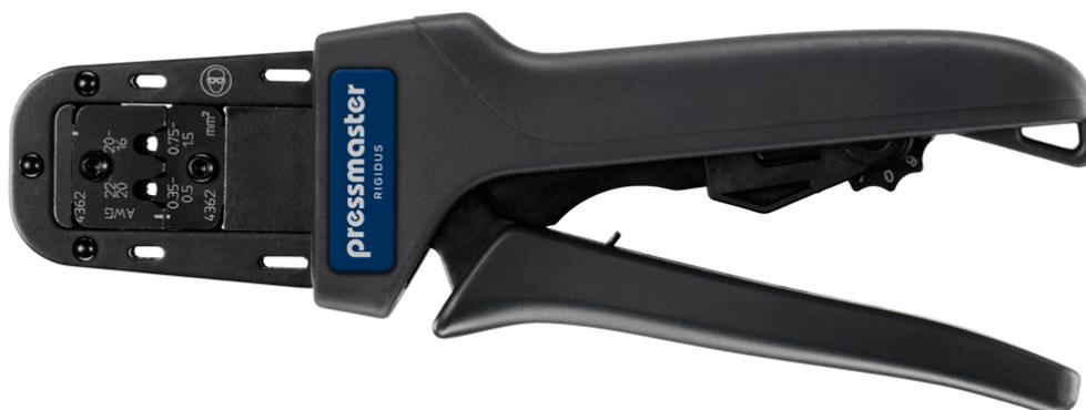
RRB-0315 est un outil de sertissage pour Superseal connecteurs étanches, connecteurs à fût ouvert non isolés, 0.35 - 1.5 mm<sup>2</sup>/AWG 22-16, sertissage « B/F ».
