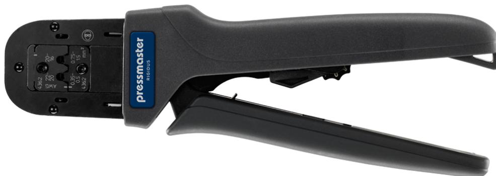
RRB-0315L est un outil de sertissage pour Superseal connecteurs étanches, connecteurs à fût ouvert non isolés, 0.35 - 1.5 mm<sup>2</sup>/AWG 22-16, sertissage « B/F ».
