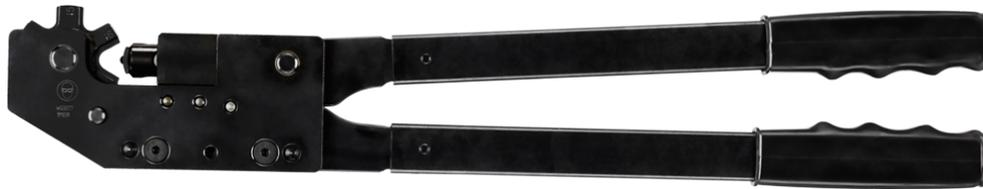
Le T3165A est un outil de sertissage des embouts tubulaires en cuivre dans la gamme 10,0-70,0 mm<sup>2</sup>/7-2/0 AWG.
