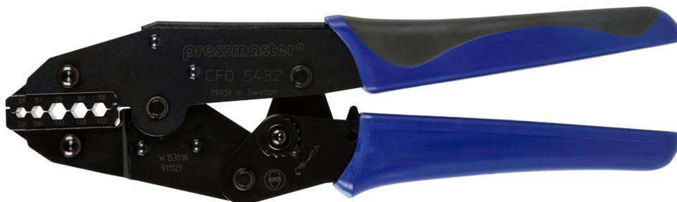
CFO-5432 è adatto per la crimpatura delle ferrule sui connettori per Fibra ottica; 3,25 mm; 3,84 mm; 5,41 mm; 5,00 mm; 4,52 mm/0,128"; 0,151"; 0,213"; 0,197"; 0,178", crimpatura "esagonale", ST, SC, SMA, SMB, SFR.
