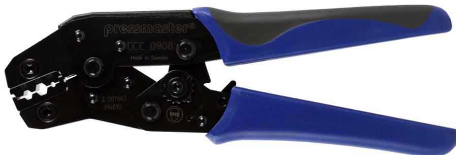
DCC-0908 è adatto per la crimpatura di Connettori Coassiali, 3,25 mm; 4,52 mm; 1,69 mm/0,128"; 0,178"; 0,067", crimpatura "esagonale".
