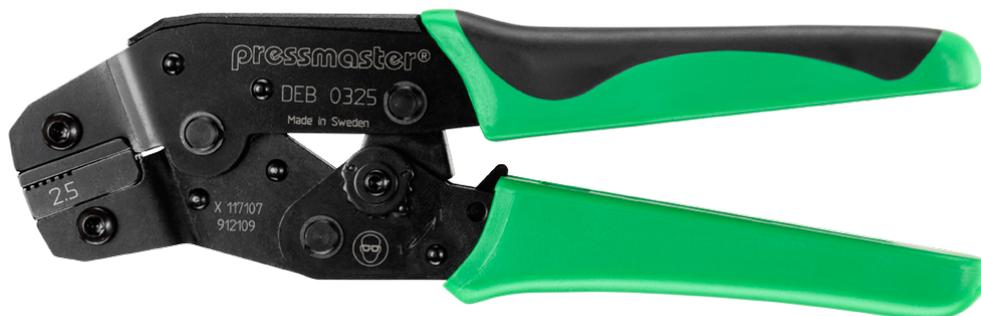
DEB-0325 è adatto per la crimpatura di puntalini DIN 46228; 0,25 mm<sup>2</sup>; 0,5 - 1,5 mm<sup>2</sup>; 2,5 mm<sup>2</sup> / AWG 24; AWG 22-16; AWG 14, per crimpatura frontale, crimpatura trapezoidale.
