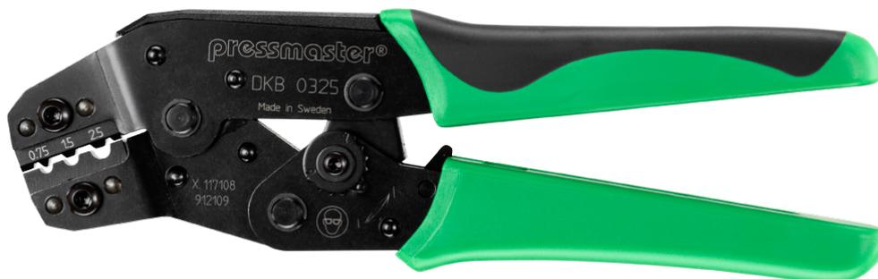
DKB-0325 è adatto per la crimpatura di capicorda non isolati, 0,5 - 2,5 mm<sup>2</sup>/AWG 22-14, Cirimpatura a punzone.
