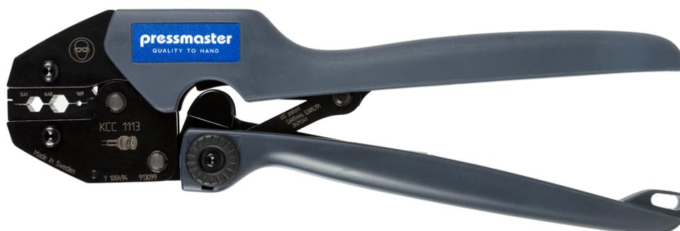
KCC-1113S è adatto per la crimpatura di connettori coassiali; 5,41 mm, 6,48 mm; 1,69 mm/0,255"; 0,213"; 0,067"; crimpatura "esagonale". Fornibile con impugnatura corta o lunga.
