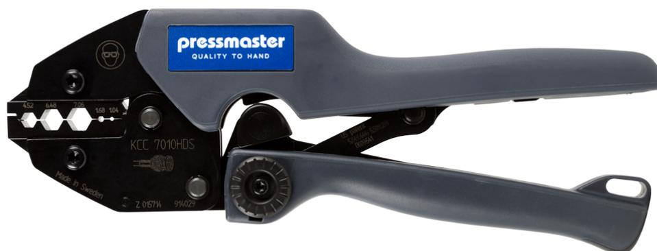
KCC-7010HD è adatto per la crimpatura di connettori coassiali, HDTV, BNC e TNC su cavi Belden 1855A, 1865A, 1505A, 1505F, 1694A, 1694F.
