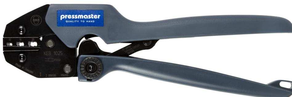
KEB-1025 è adatto per la crimpatura di puntalini DIN 46228; 10 mm<sup>2</sup> - 25 mm<sup>2</sup>/AWG 6-4, per crimpaggio laterale, crimpatura trapezoidale.
