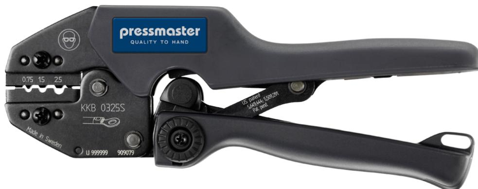
KKB-0325S è adatto per la crimpatura di capicorda non isolati, 0,5 - 2,5 mm<sup>2</sup>/AWG 22-14, Indent-Crimp.
