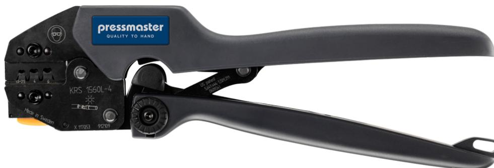
KRS-1560L-4 è adatto per la crimpatura di Contatti di connettori Fotovoltaici come MC4™ e similari, Ø 4 mm/0,157", crimpatura "B"/"F" 1,5 - 2,5; 4,0; 6,0 mm<sup>2</sup>/AWG 16 - 14; 12; 10. Questo utensile è fornibile anche nelle versioni per connettori MC3™ e SOLARLOK™. (MC3™ e MC4™ sono marchi di proprietà di Multi-Holding AG, Switzerland. SOLARLOK™ è un marchio di proprietà di TE Connectivity, USA).
