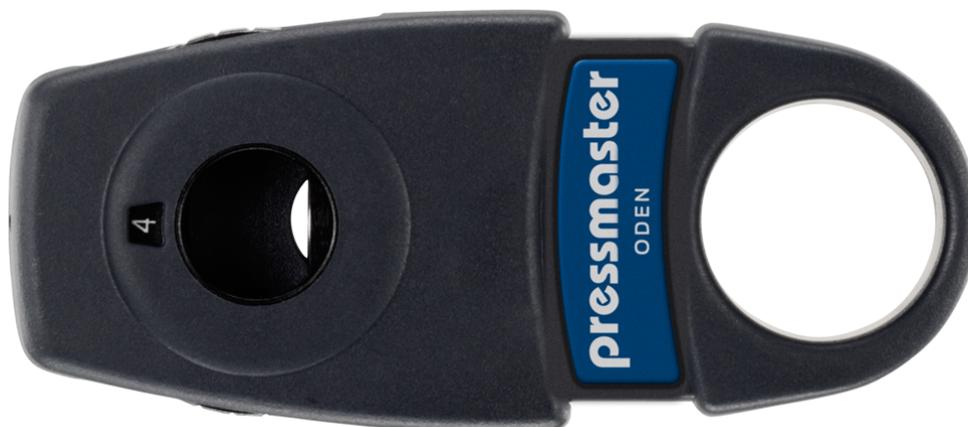
Oden è un utensile spelafili di precisione per rimuovere le guaine dei cavi di segnale, telefonici, audio-video, di strumenti, di trasmissione dati di rame e in fibra ottica. Fino a un diametro di 11 mm/0,43 pollici.
