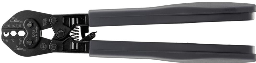
Il modello T2258 è adatto per la crimpatura di connettori tubolari non isolati di 4-16 mm<sup>2</sup>/11-5 AWG.
