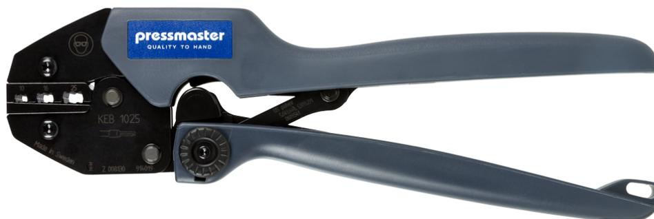
KEB-1025 es una herramienta crimpadora para conectores punta-punta finales conforme a la norma 46228; 10 mm<sup>2</sup> - 25 mm<sup>2</sup>/AWG 6-4, con acceso lateral, alicate para entallado trapezoidal.
